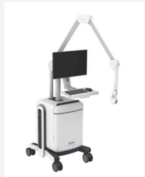
▲ 系統包含超過128個獨立陣元的經顱稀疏超聲陣列，配合定製驅動系統，以超聲波穿透人體的顱骨，精準聚焦深腦區域。
